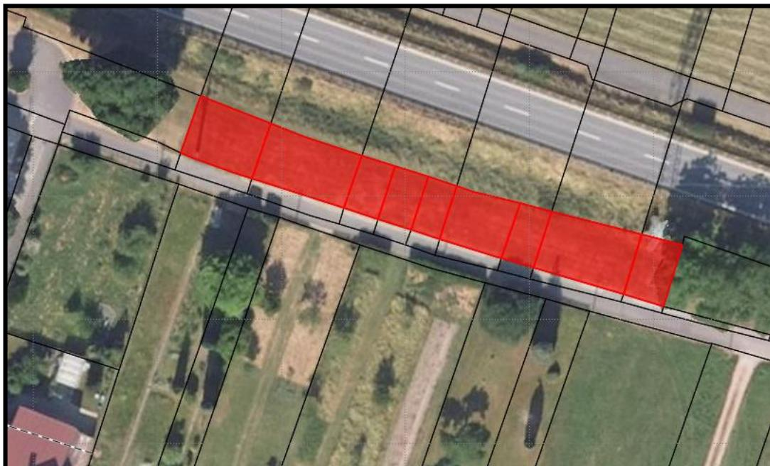
Vorstellbar ist, nach dem Kastanienbaum bzw. im Anschluss des Strommastes in Fahrtrichtung Freudenberg ca. 15-20 Stellplätze (Senkrechtaufstellung; gerades Einparken, 90° zur Fahrgasse), in den Maßen 6,0 m Tiefe und 2,70 m Breite sowie einen Wendeplatz zu errichten.
